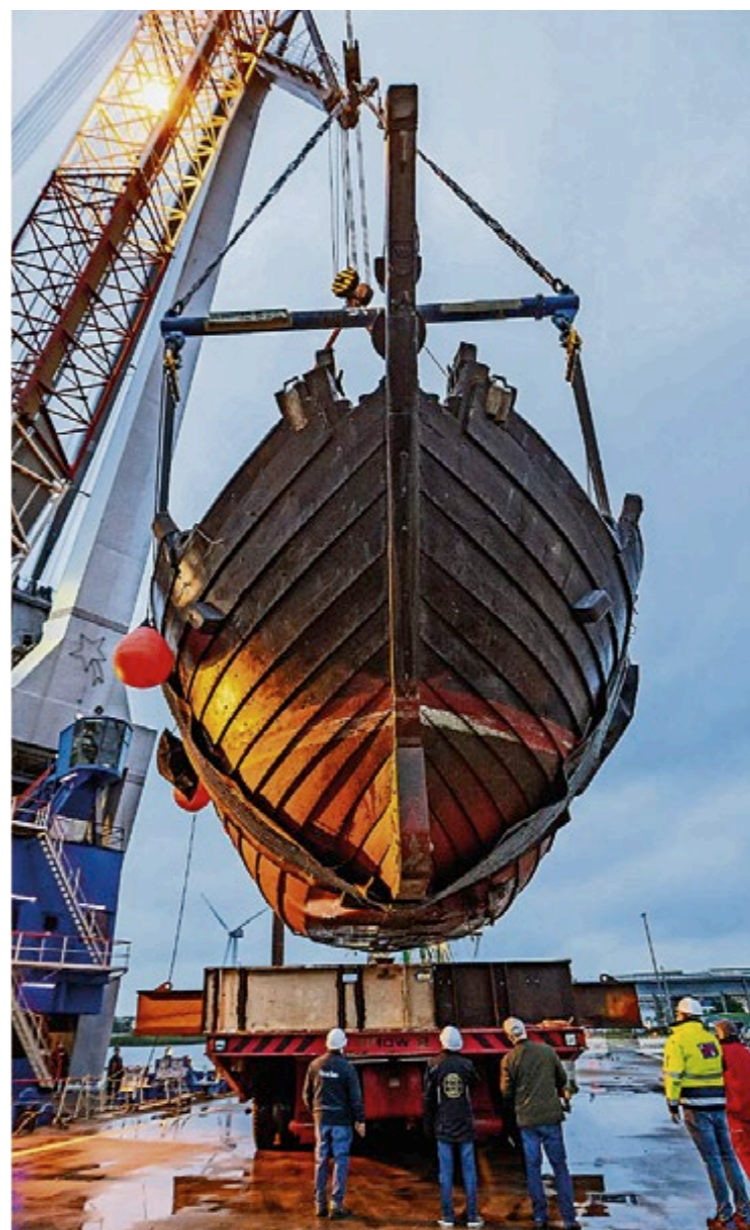
Vorsichtig wird die Hansekogge „UBENA von BEMEN“ auf dem Schwerlast-Transportmodul abgesetzt. Sie hängt in besonderen Gurten. Fotos: Scheschonka
